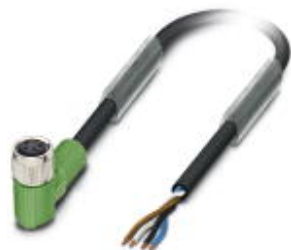
Sensor-/Aktor-Kabel, 4-polig, PVC, schwarz RAL 9005, freies Leitungsende, auf Buchse gewinkelt M8, Kabellänge: 3 m
