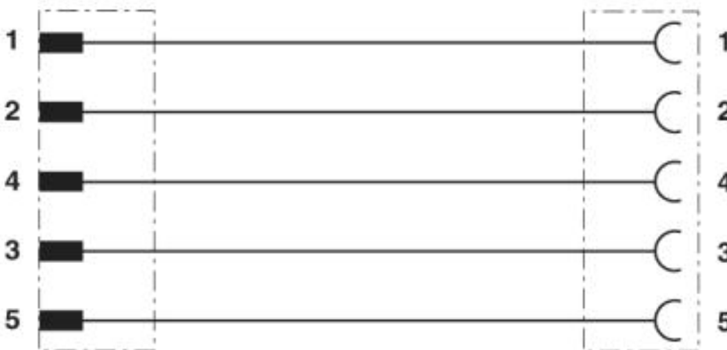
Kontaktbelegung des M12-Stecker und der M12-Buchse
